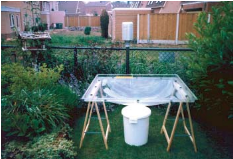
Figuur 27 Regenmeter met op de voorgrond de opvangconstructie voor de kwaliteitsmeting van het regenwater
