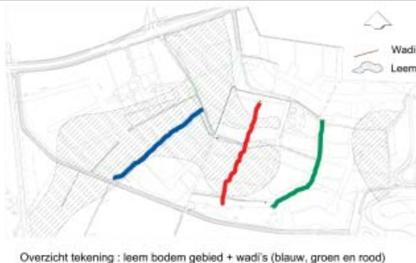
Figuur 11 Aanwezigheid van leemlagen en wadistructuur in Ruwenbos
