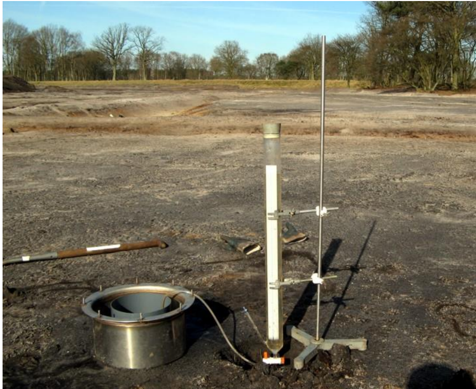
Figuur 1: Proef opzet met dubbele ringinfiltrometer opstelling (links) met de Mariottbuis (rechts)
